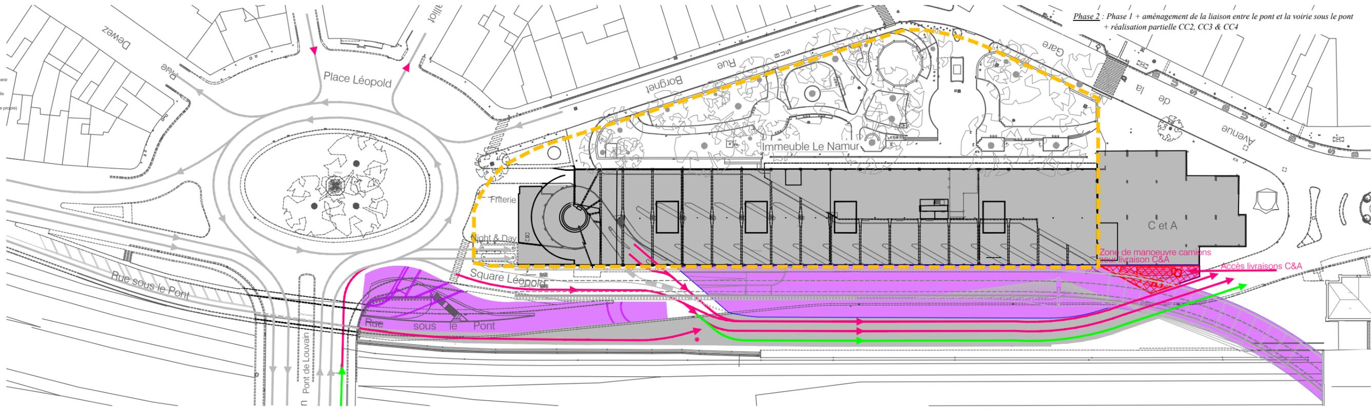
2.Phase 1 +aménagement de la liaison entre le pont et la voirie sous le pont + Réalisation partielle CC2, CC3 & CC4
