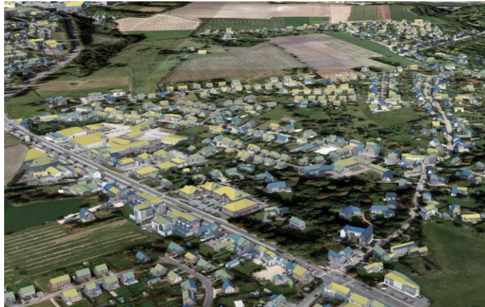
Potentiel photovoltaïque dans le quartier du vieil Erpent
